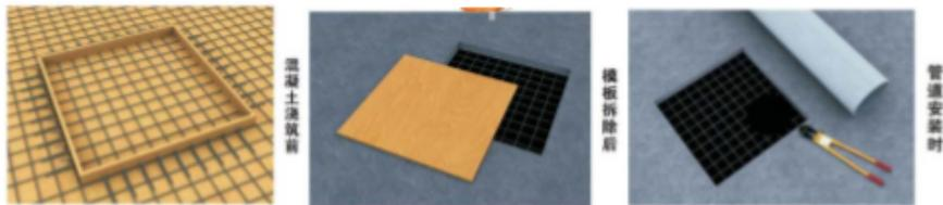
方式二：根据洞口尺寸大小，采用相当长度的木枋卡在洞口内，然后将硬质盖板用铁钉钉在木枋上，作为硬质防护，盖板四周要求顺直，刷警示漆。
