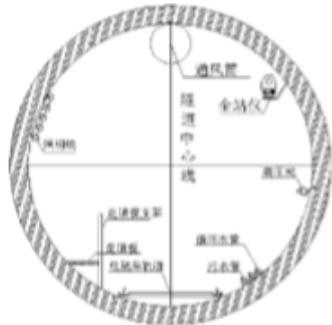
盾构隧道内管线布置剖面示意图
