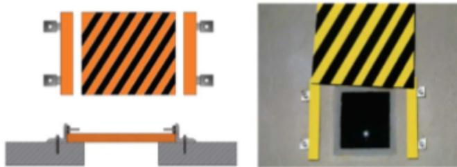
2.2.3 洞口防护短边尺寸 $\geq 1500\text{mm}$ ，四周应设置符合临边防护标准的防护栏杆（采用三道栏杆形式，立杆高度 1300mm，下道栏杆离地 200mm，中道栏杆离地 600mm，上道栏杆离地 1200mm），下口设置踢脚板并张挂水平安全网，防护栏杆距离洞口边不得小于 200mm。栏杆表面刷红白相间警示油漆。
